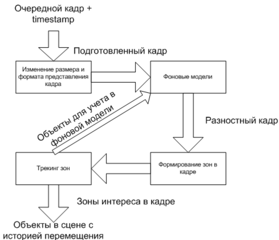
Рис. 4. Схема работы анализа видеопотока
